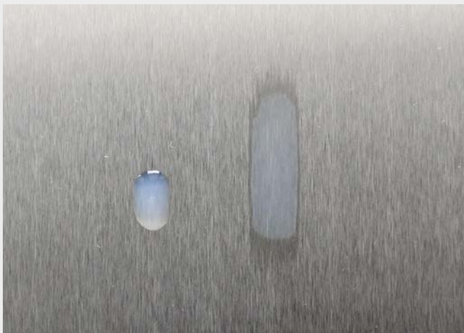
Benetzungsfähigkeit nach 60 Sek. im Vergleich: NOVAMET 920 (rechts) und ein herkömmlicher Kühlschmierstoff (links) auf VA-Stahl
