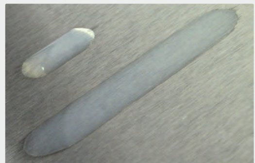
Vergleich von NOVAMET 760 (rechts) und herkömmlichem Kühlschmierstoff (links): Die ausgezeichnete Benetzungsfähigkeit sorgt für verbesserte Schmier- und Kühlleistung.
